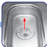
拆喷淋泵滤网 并清洗
