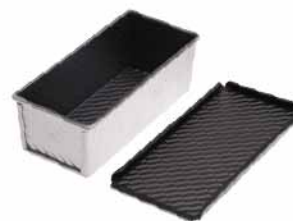
385g波纹土司盒(1000系列不沾) 1.0mm铝合金 SN2083 内径217x94x77mm 面团建议克重:375g; 蛋糕建议克重:500g
