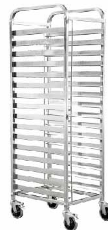
不锈钢 16层固定式不锈钢台车 SN1971 620x470x1730mm 配套600x400mm烤盘 层高85mm
