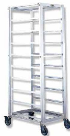
铝合金 9层固定式铝合金台车(阳极) SN1996 603x471x1695mm 配套600x400mm烤盘 层高160mm
