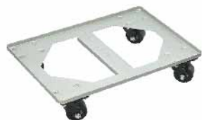
配套600x400mm烤盘 平台车(烤漆) 2.5mm碳钢 SN1982 610x410x125mm (耐重800kg)
