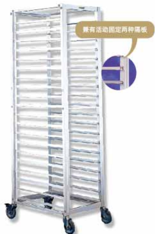
铝合金 20层活动式铝合金台车(阳极) SN1992 600x471x1862mm 配套600x400mm烤盘 层高80mm
