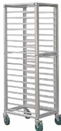
铝合金+聚碳酸酯(PC) 18层固定密封式铝合金台车(阳极) SN1961 628x486x1700mm 配套600x400mm烤盘 层高80mm
