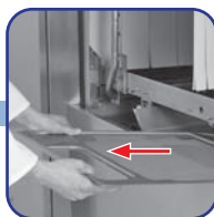
拆水箱过滤板并清洗
