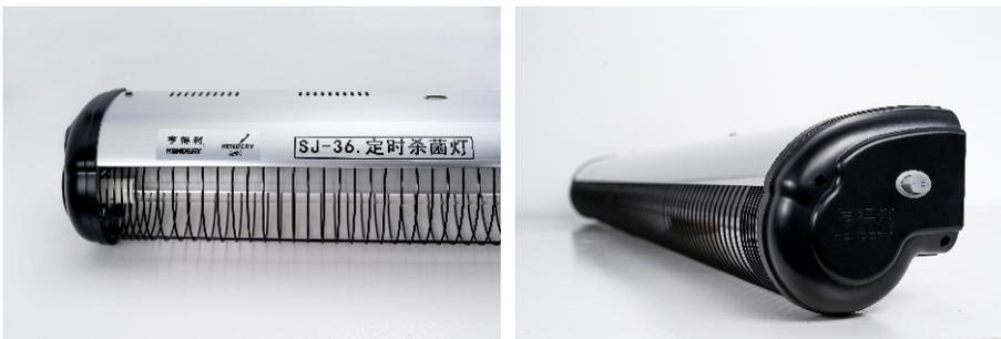
Sj系列杀菌灯管设计在在机器前置部分，腔内有电镀反射层，能扩大紫外线光波的覆盖面积。紫外线杀菌灯波长在260nm左右，除杀菌外还会伤害人和动植物，所以在使用本机的杀菌功能时，人员和动物等应离开消毒现场，以避免被紫外线灼伤。
