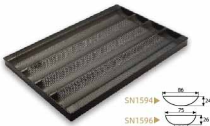
4槽法国烤盘(1000系列不沾) 铝合金 SN1594 600x400x33mm / 86x24mm SN1596 600x400x33mm / 75x24x26mm
